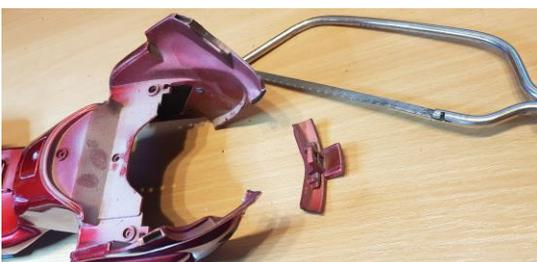
12. Staufächer und Radio Entfernen 3 Schrauben wobei sich der in der Mitte erst nach Entfernung des Lenker Rausschrauben läßt.
