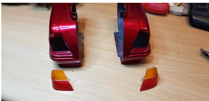
19. Heckteil mit Nummernschild Raushebeln, vorher Schmelzstellen Bearbeiten! Rückstrahler Entfernen.
