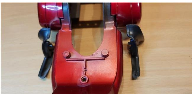
16. Seitliche Lüftungsöffnungen Entfernen. Ränder der Schmelzpunkte Bearbeiten bis die Teile Rausgehen.
